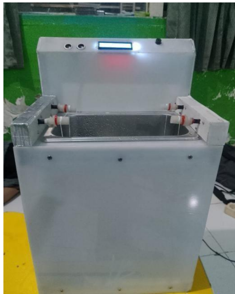
Gambar 4. 1 Hasil Akhir Alat Bantu Proses Sterilisasi Otomatis Berbantuan Vibrator Berbasis Arduino Uno
