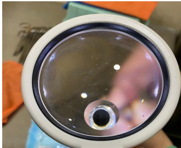
Gambar 4. 5 Pemeriksaan lubang instrumen menggunakan kaca pembesar
