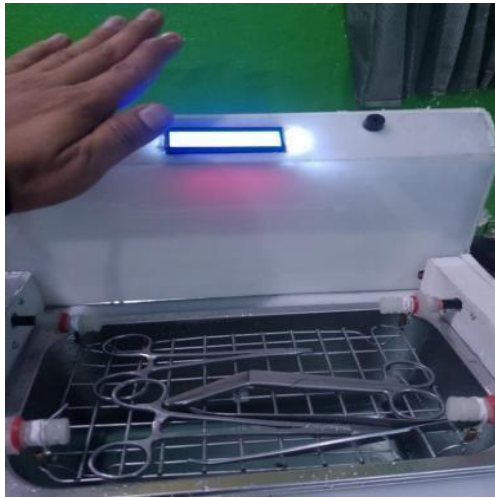
Gambar 4. 8 Meletakkan tangan pada sensor ultrasonic untuk memulai program
